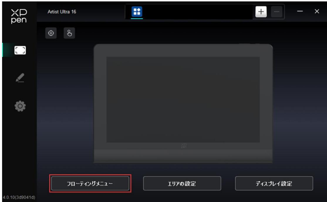
フローティングメニューは横並び表示と縦並び表示に対応しています。左上エリアをタップして表示方式を切り替え、右上の「表示」ボタンをタップすると、フローティングメニューがデスクトップに表示されます。
